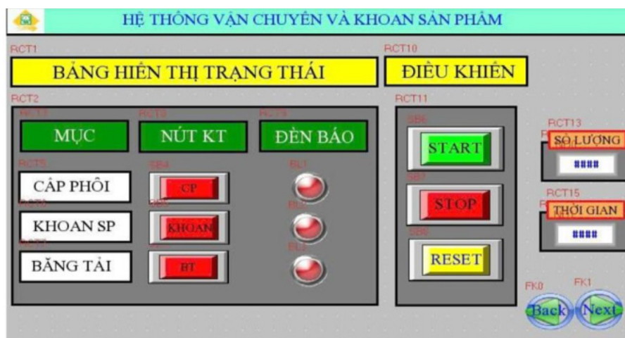
Hình 4. Giao diện điều khiển tín hiệu ngoại vi HMI
